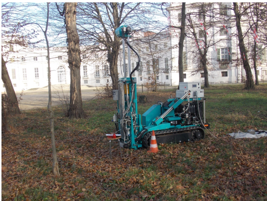
Foto 2 - Prova Penetrometrica Dinamica Pesante SCPT P1
