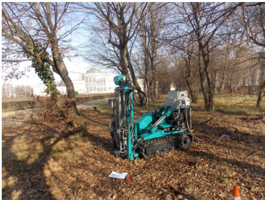
Foto 3 - Prova Penetrometrica Dinamica Pesante SCPT P2
